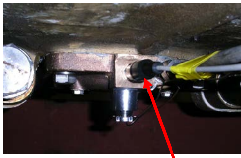
特殊軸受部に取り付けた振動センサ
